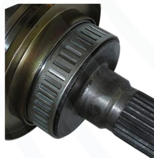
Por lo general, las juntas de CV se presionan con anillos de muelle. Asegúrese de que la cantidad de dientes o ventanas coincida con el eje original.
