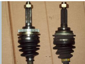
5. Se deben inspeccionar cuidadosamente los ejes con sujetadores circulares en el eje estriado interno para garantizar que no hayan quedado partes o fragmentos de metal en el diferencial.
