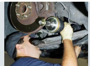
8. Cuando instale todos los ejes de CV, NO los deje colgando del diferencial o del eje transversal en ningún momento durante la instalación. La tensión aplicada puede dañar la junta interna y provocar que el eje no funcione correctamente.
