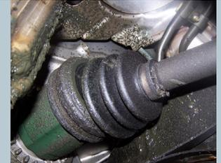
7. Luego de instalar un eje con sujetador circular en la transmisión, revíselo para asegurarse de que el eje esté correctamente asentado en la transmisión tirando lentamente de la carcasa interna.
